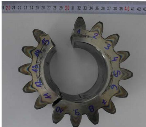
Bild 1: Geschädigtes Ritzelrad
