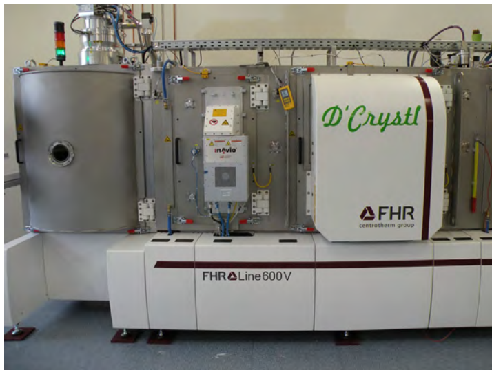
Rohrkathodensputteranlage mit Schleusen- und Vorbehandlungs-/Beschichtungskammer
