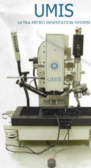
Zwei separate LVDT-Sensoren (linear variable differential transformer) werden zur unabhängigen Messung von Kraft und Eindringtiefe verwendet und erlauben hochpräzise Messungen.
