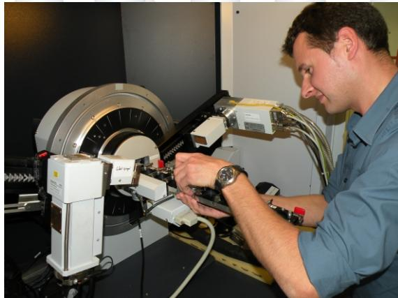
Die Probe wird mit monochromatischem Röntgenlicht bestrahlt und die Beugung dieser Strahlung am Kristallgitter detektiert. Beim Durchfahren eines vordefinierten Winkelbereiches wird nach jenen Reflexwinkeln gesucht, bei denen sich Intensitätsmaxima ausbilden.
