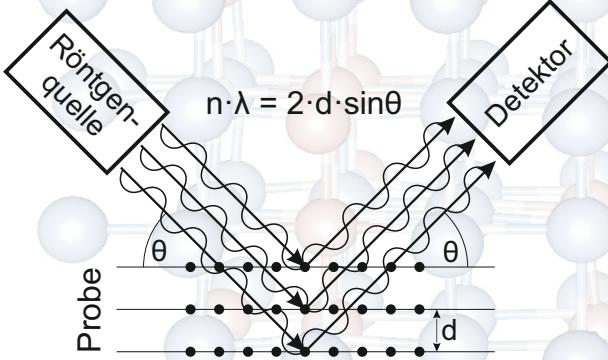
Die gemessenen Reflexwinkel sind ausschlaggebend für die Phasenbestimmung. Diese Methode ermöglicht eine zerstörungsfreie, strukturelle Untersuchung der Proben und liefert Informationen über Gitterkonstante, Korngröße und den Spannungszustand.
