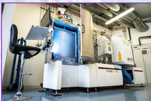
Durchlaufsputteranlage für Schichten
