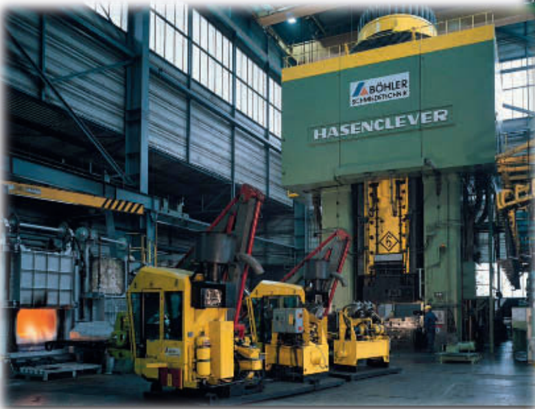
Ein Highlight der Exkursion ist die Besichtigung der weltgrößten Spindelpresse mit einer Schlagkraft von 315 MN zum Schmieden von Turbinenschaufeln
